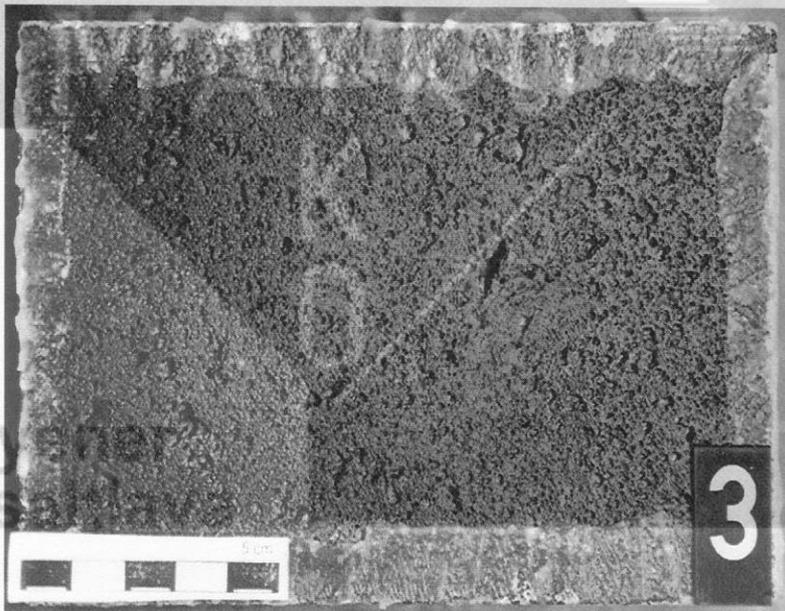
**Bild 7:** Probe 3 nach der Frost-Tausalz-Wechselagerung, Farbänderung gegenüber Bild 6 aufgrund der Lichtverhältnisse, keine Farbveränderung der Probe
