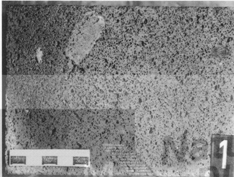
**Bild 2:** Probe 1 vor der Frost-Tausalz-Wechselagerung, Farbe abhängig von Lichtverhältnissen
